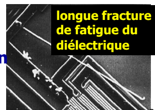
Extrusion d'aluminium à travers la passivation
